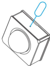
Zaženite aplikacijo eWeLink, Izberite RF Bridge, ki ga želite povezati, kliknite "Add" in izberite "Alarm", nato boste zaslišali pisk, ki indicira, da je RF Bridge prešel v način seznanjanja. Potem na kratko pritisnite tipko za seznanjanje na napravi. Seznanjanje je uspešno, ko rdeč LED indikator zagori za 1s in zaslišite dvojni pisk na RF Bridgu.
