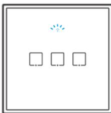
Ob prvem vklopu bo naprava samodejno prešla v način hitrega seznanjanja. Wi-Fi LED indikator bo začel izmenjujoče utripati z dvema kratkima in enim dolgim utripom.
